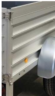
Einwandiges System, erkennbar an den äußeren Absätzen
