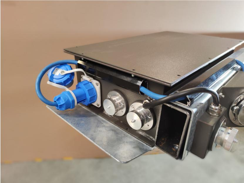
Sämtliche Anschlüsse in Ausführung IP68.
