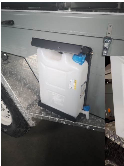
Wasserkanister 20 Liter mit Auslaufhahn. Der Hahn ist demontierbar und wird dann in einer Halterung am Kanister befestigt.
